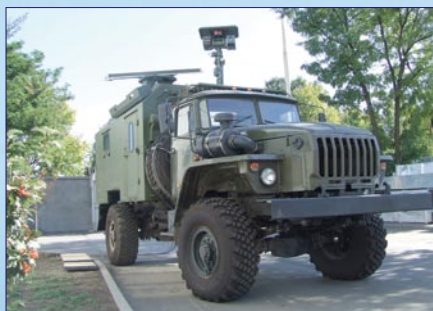
МОБИЛЬНЫЙ РАДИОЛОКАЦИОННО-ТЕПЛОВИЗИОННЫЙ КОМПЛЕКС КОНТРОЛЯ ЗА НАДВОДНОЙ ОБСТАНОВКОЙ «НАЯДА ТВП-М»
